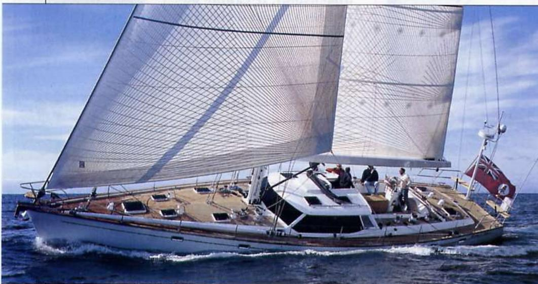
Sopra, il Farr 63 PH in navigazione. Le linee d'acqua potenti e i pesi concentrati garantiscono buone prestazioni a vela e un passaggio morbido sull'onda.
